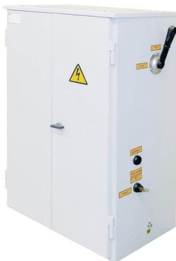
Панели защитные крановые типа ПЗКБ-160У2, ПЗКБ-250У2, ПЗКБ-400У2 предназначены для максимально-токовой и нулевой защиты крановых электродвигателей переменного тока с фазным ротором.
