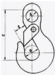
Заготовка крюка чалочного с отверстием под чалку
